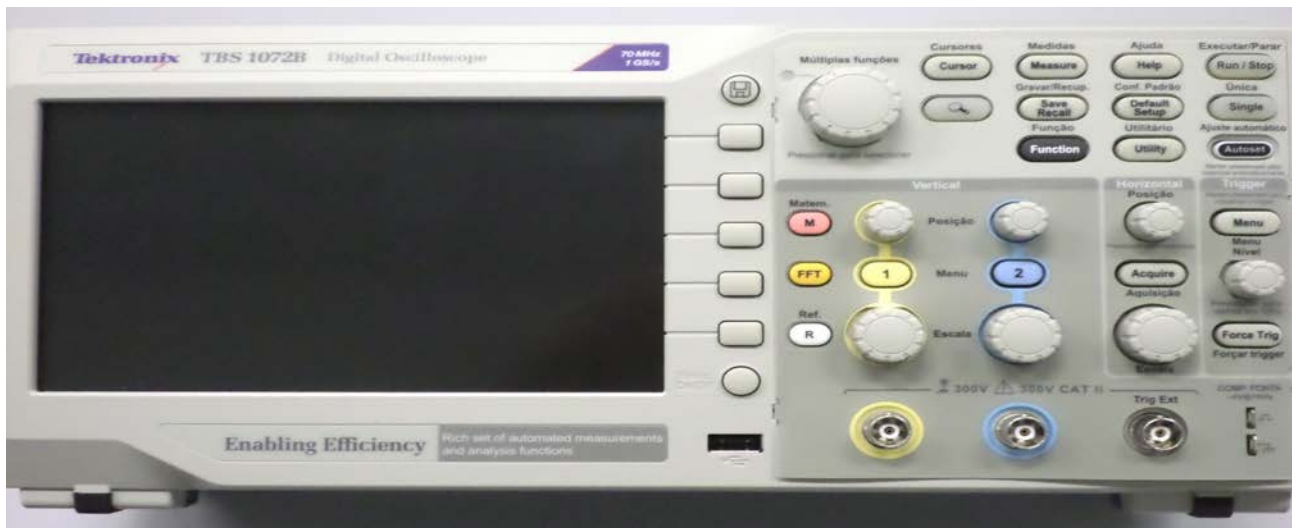
FIGURA 1 - Osciloscópio Digital, 70 MHz, amostragem 1GS/s, modelo TBS1072 B. marca TEKTRONIX
